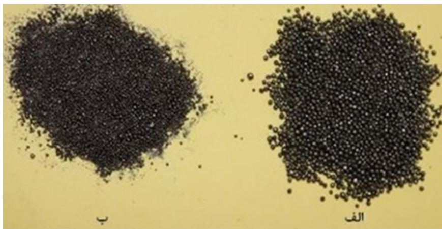
شکل 1 ساچمه‌های فولادی به کار رفته در آزمایش، الف) قطر / ، ب) قطر
