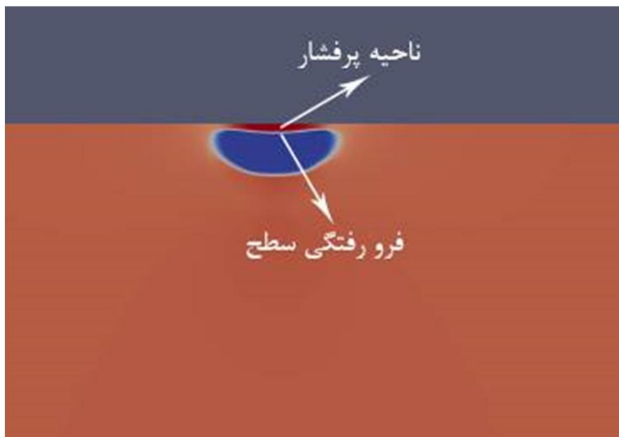
شکل 29 نمایش گودی بالای حباب ناشی از افزایش فشار
