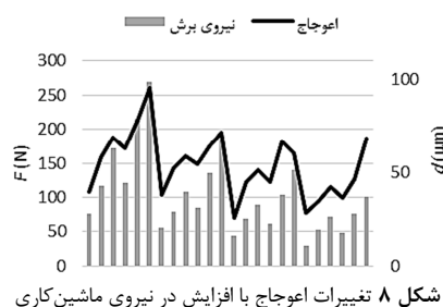
شکل ۸ تغییرات اعوجاج با افزایش در نیروی ماشین‌کاری
