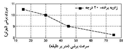
شکل ۱۱: تغییرات نیروی برشی با افزایش سرعت برشی
