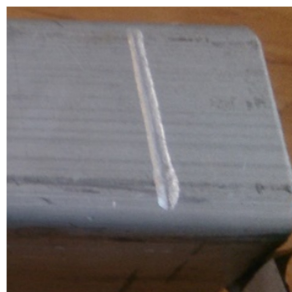
شکل ۵ نمونه منحنی ماشین کاری شده توسط دستگاه هگزاپاد بر روی آلومینیوم
