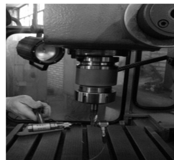
شکل ۳ نحوه انجام آزمایش مودال ابزار
