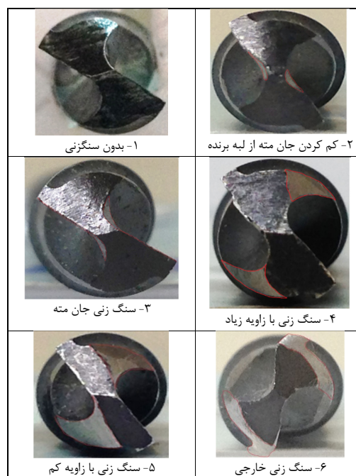
شکل ۲ طرح‌های مختلف سنگ‌زنی سر مته
