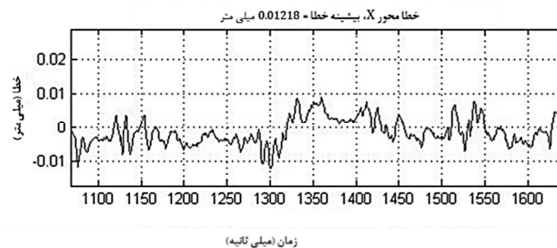
شکل ۵ خطا حرکت در سه محور مسیر منحنی ایرفویل NACA0025 سه بعدی
