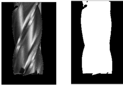
شکل ۳ تصویر قطعه‌بندی شده (الف) باینری (ب) خاکستری
