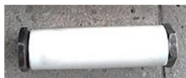
شکل ۴ پوسته پلی آمیدی نگه دارنده برس ساینده و قطعه‌کار
