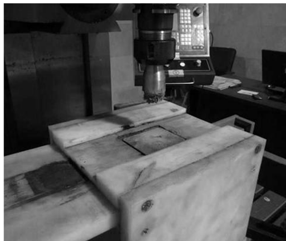
شکل ۴ انجام فرایند پرداخت کاری سایشی مغناطیسی بر سطوح اینکونل
