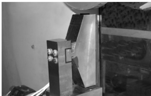
شکل ۳ نگهدارنده قطعه کار ساخته شده توسط لیانگ [۴]
