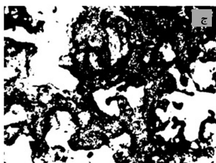
شکل ۶ پردازش تصویر، (الف) تصویر اصلی گرفته شده توسط دوربین، (ب) تصویر سطح چرخ سنگ پس از دی نویزینگ، (ج) تصویر باینری شده توسط نرم افزار متلب، (سنگ زنی با روان کاری کمینه گاز آرگون، عمق درسینگ: ۱۵ میکرون و سرعت پیشروی درس: ۶۰۰ میلیمتر بر دقیقه).
