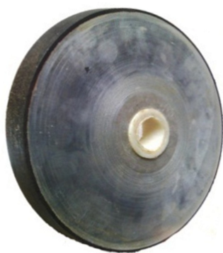
شکل ۱ چرخ سنگ فوق ساینده مورد استفاده
