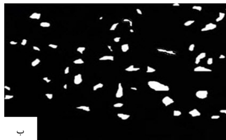
شکل ۸ سطح چرخ سنگ بعد از سنگ زنی در حضور امولسیون (الف) تصویر پردازش شده (درصد لودینگ ۶/۳۴۰) (ب)
