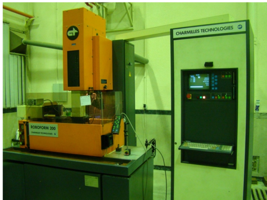
شکل ۴ دستگاه اسپارک مورد استفاده در آزمایشات
