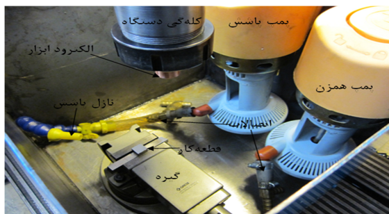
ب) نحوه قرارگیری پمپها، اتصالات، گیره و کله گی درون مخزن شکل ۳ تجهیزات مورد استفاده در آزمایشات ماشین کاری تخلیه الکتریکی به کمک پودر
