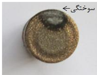
شکل ۷ سوختگی ابزار مس-قلع
