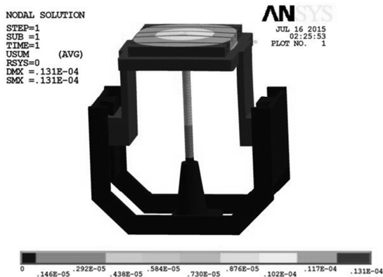
شکل ۴ نتایج تغییر شکل کلی ماکزیمی ۱۳ میکرون میز
