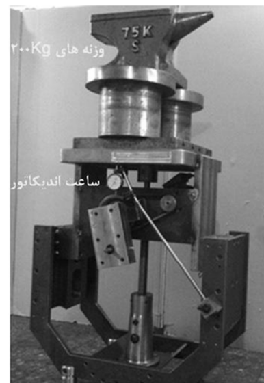
شکل ۸ آزمایش عملی تغییر شکل سازه میز در راستای محور Z به میزان ماکزیمم ۱۱ میکرون
