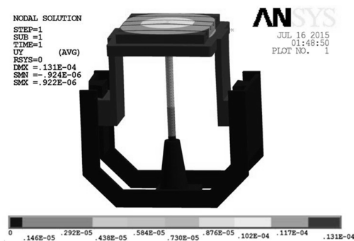
شکل ۵ نتایج تغییر شکل میز به میزان ماکزیمم ۲ میکرون در جهت محور ۷
