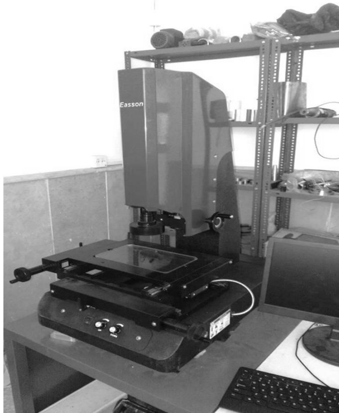
شکل 2 دستگاه VMM استفاده شده برای اندازه‌گیری زوایای ابزار
