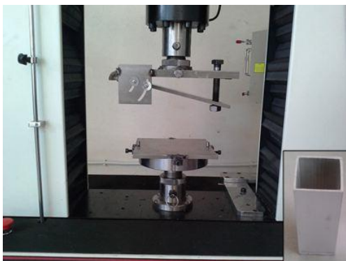
Fig. 3 Universal test machine together with a sample of square tube شکل 3 دستگاه تست یونیورسال به همراه نمونه لوله مربعی
