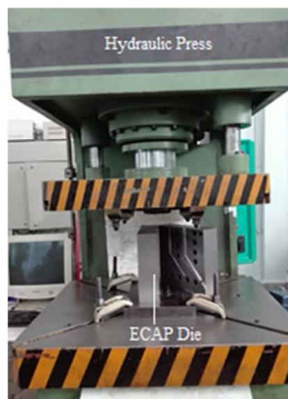
Fig. 4 Hydraulic press and ECAP die setup.
