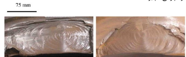
شکل ۱ شکست دو چرخ فولادی قطار در اثر رشد ترک زیرسطحی بیضوی [۸]
