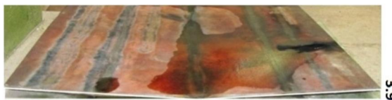
شکل 5 انحنای ورق بعد از پاس حرارتی اول
