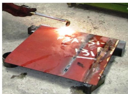
شکل 8 انجام روش حرارت خطی بر روی ورق ضخامت 4 میلی‌متر
