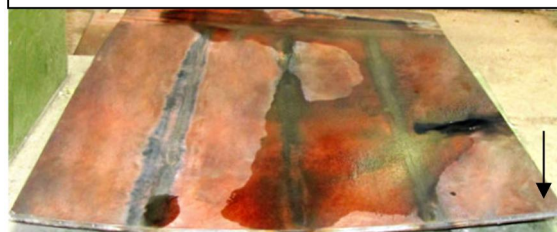
شکل 5 انحنای ورق بعد از پاس حرارتی اول
