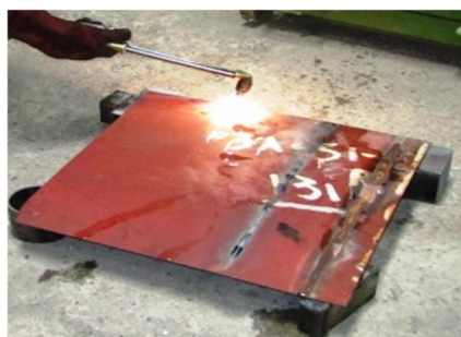
شکل 8 انجام روش حرارت خطی بروی ورق ضخامت 4 میلی‌متر
