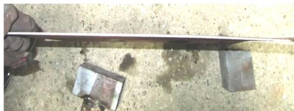
شکل 9 نتیجه اجرای آزمایش بر روی ورق ضخامت 4 میلی‌متر (بعد از اجرای آزمایش انحنای محدب در ورق ایجاد شد)
