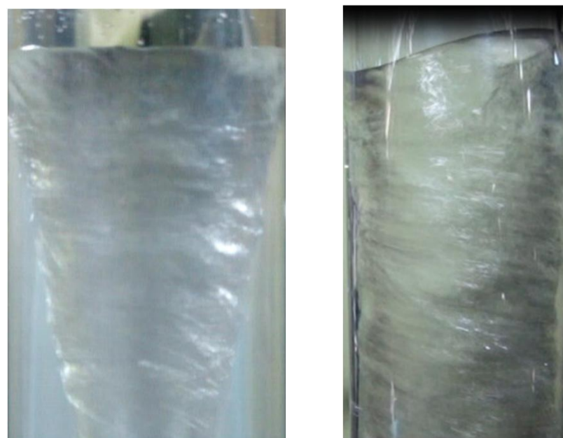
شکل 12 تاثیر قطر محفظه بر یکنواختی جریان گردابه‌ای
