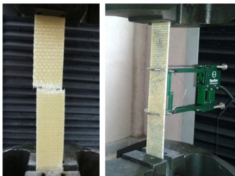
شکل ۲ نمونه تحت کشش، قبل و بعد از شکست
