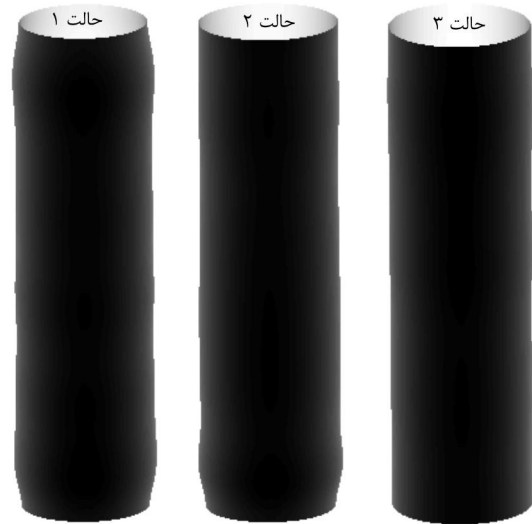
شکل 7 نمایش سه بعدی پوسته کمانش یافته برای حالت‌های 1، 2 و 3 در سرعت 120 متر بر ثانیه بر اساس تئوری حاضر
