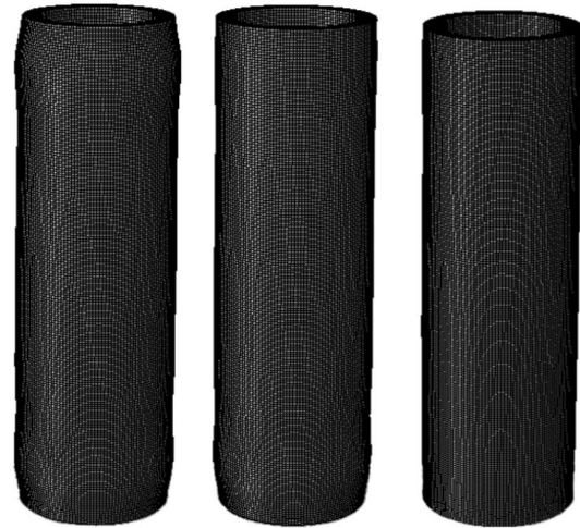
شکل 6 نمایش سه بعدی پوسته کمانش یافته برای حالت‌های 1، 2 و 3 در سرعت 120 متر بر ثانیه بر اساس نرم‌افزار آباکس
