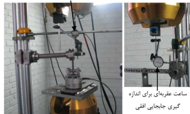
شکل 3 فیکسچر مورد استفاده در بارگذاری مرکب تناوبی
