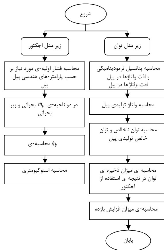
شکل 4 روند محاسبات مدل برای محاسبه میزان افزایش بازده سیستم
