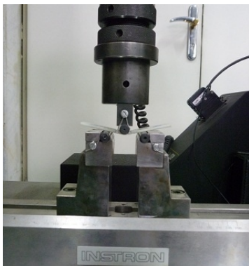
شکل ۲ نمونه تحت آزمایش خمش سه نقطه‌ای
