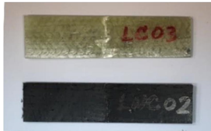
شکل 18 نمونه‌های خمشی پس از آزمایش
