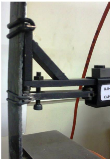
شکل 7 یک نمونه از آزمایش کشش
