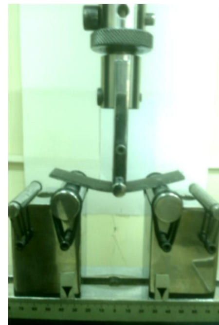
شکل 8 یک نمونه از آزمایش خمش سه نقطه
