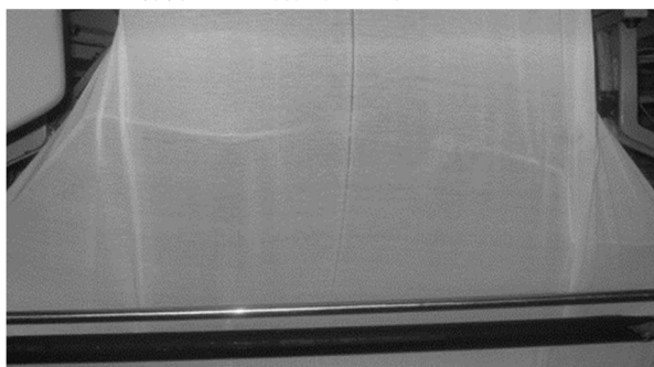
شکل 6 اعمال عیب چهار سوزن شکسته در پارچه
