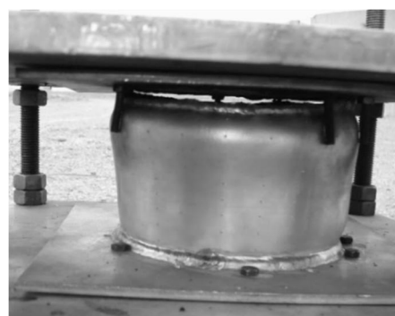
شکل 17 پارگی در محل اتصال ورق به پوسته
