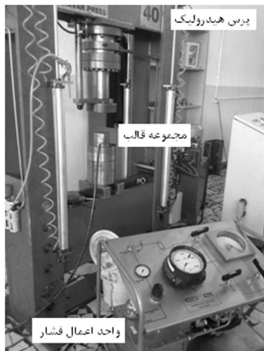
شکل 7 واحد اعمال فشار، پرس و تجهیزات مورد نیاز
