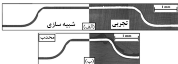
شکل 15 مقایسه نتایج تجربی و شبیه‌سازی توزیع ضخامت و عمق شکل داده شده نمونه‌ها در فشار 80 مگاپاسگال و در راستای (الف) طولی، (ب) عرضی
