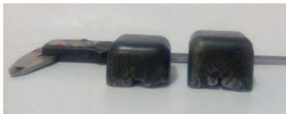
Fig. 13 Samples produced by hydro mechanical deep drawing with drawing ratios of 1.8 and 2.2 شکل 13 نمونه‌های تولید شده به روش کشش عمیق هیدرومکانیکی با نسبت کشش 2.2 و 1.8
