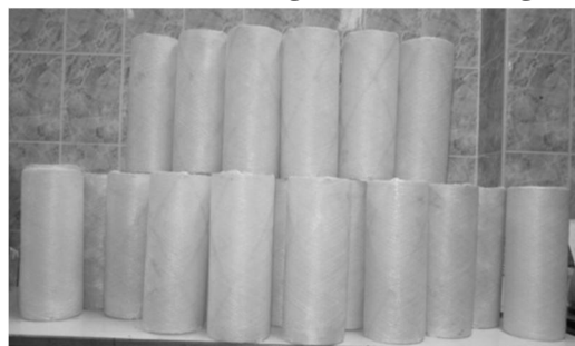
شکل 1 پوسته‌های مشبک نانوکامپوزیتی تولید شده به روش پیچش ایلف
