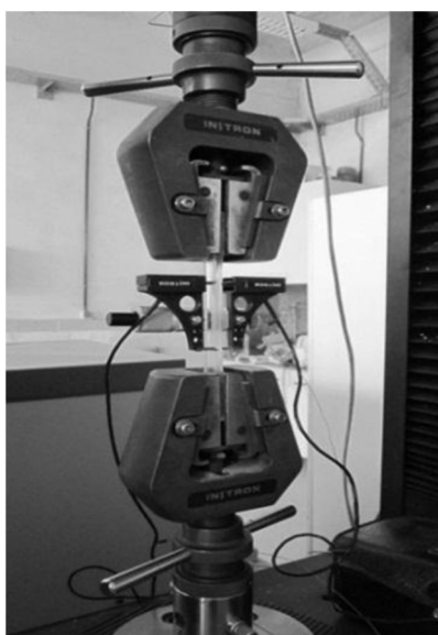
شکل 3 نمونه نانوکامپوزیتی تحت کشش تک محوری
