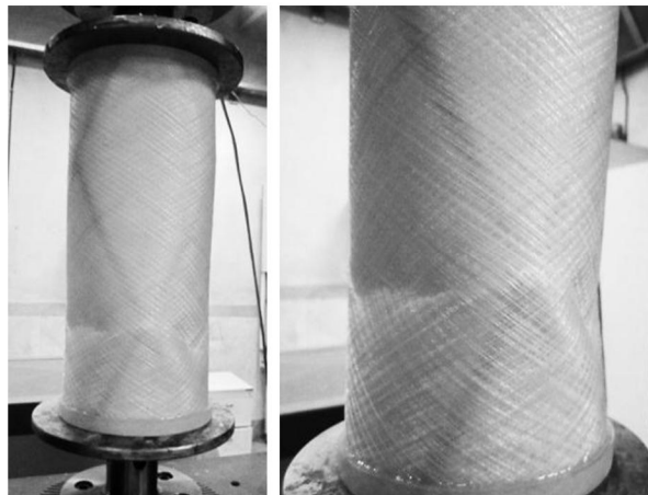
شکل ۸ پوسته‌های مشبک نانوکامپوزیتی پس از کمانش.
