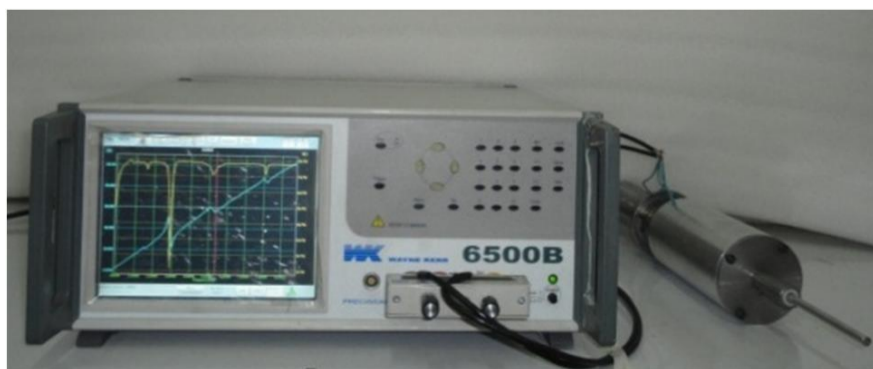
شکل 2 اندازه‌گیری فرکانس رزونانس ترانسدیوسر
