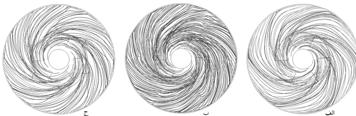
شکل 15 خطوط جریان در پروانه‌های مختلف در نقطه‌ی بهترین بازده (الف) نوع اول (ب) نوع دوم (ج) نوع سوم
