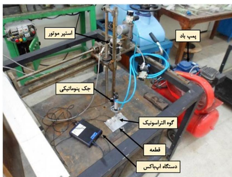
شکل 6 تجهیزات مورد استفاده در روش ترانسونیک
