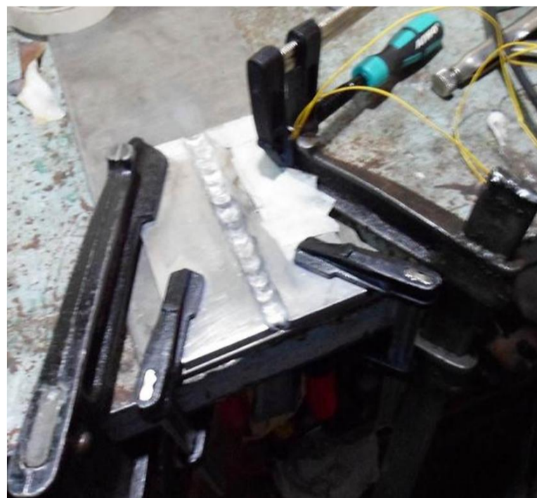
شکل 1 شرایط و قیدوبندهای جوش کاری
