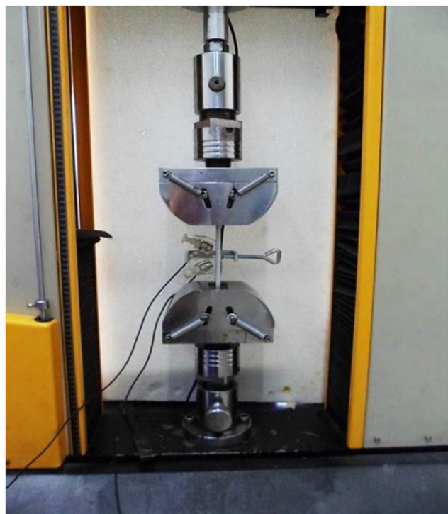
شکل 7 اندازه‌گیری ضریب آکستوالاستیک
