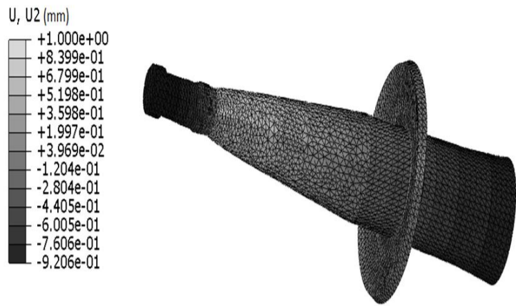
شکل 6 تحلیل نهایی ابزار ارتعاشی به منظور محاسبه فرکانس تشدید
