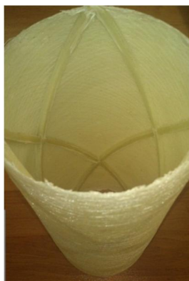
شکل 2 نمونه سالم جداشده از قالب
