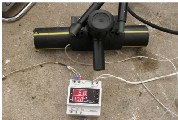
شکل 5 نحوه قرار دادن ترموکوپل جهت مقایسه نتایج شبیه سازی با نتایج در عمل
