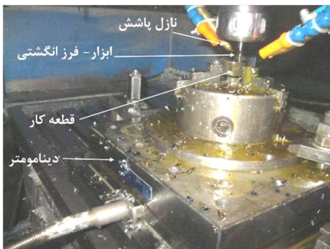
شکل 3 نمایی از چگونگی چیدمان وسایل آزمایش
