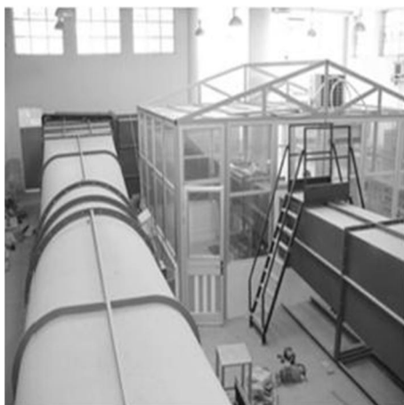
شکل 1 تونل باد مدار بسته مادون صوت
