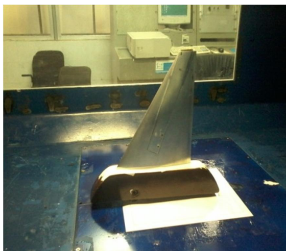
ب- نحوه قرارگیری مدل در مقطع آزمون
