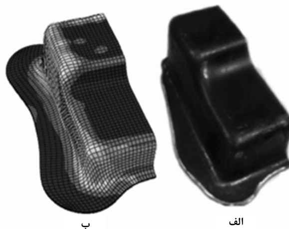
شکل 13 قطعه کنار پله بدست آمده در فشار 40، الف- آزمایشگاهی، ب- شبیه سازی
