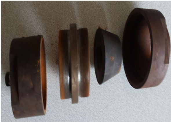
شکل 9 اجزای موتور از چپ به راست: محل قرارگیری آتشزنه و فشارسنج، محل قرارگیری سوخت، نازل گرافیتی و سر انتهایی موتور
