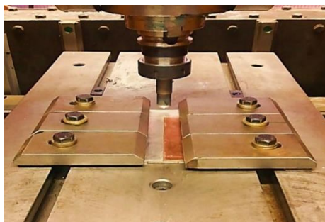
شکل ۲) دستگاه جوشکاری اصطکاکی-اغتشاشی و انجام جوشکاری با ابزار فولادی
