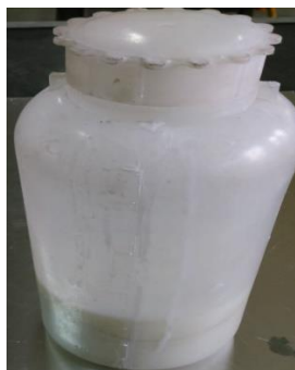
شکل ۱) پارچه از جنس شیشه E-Glass و محلول تفلون با درصد وزنی ۶۰ درصد.
