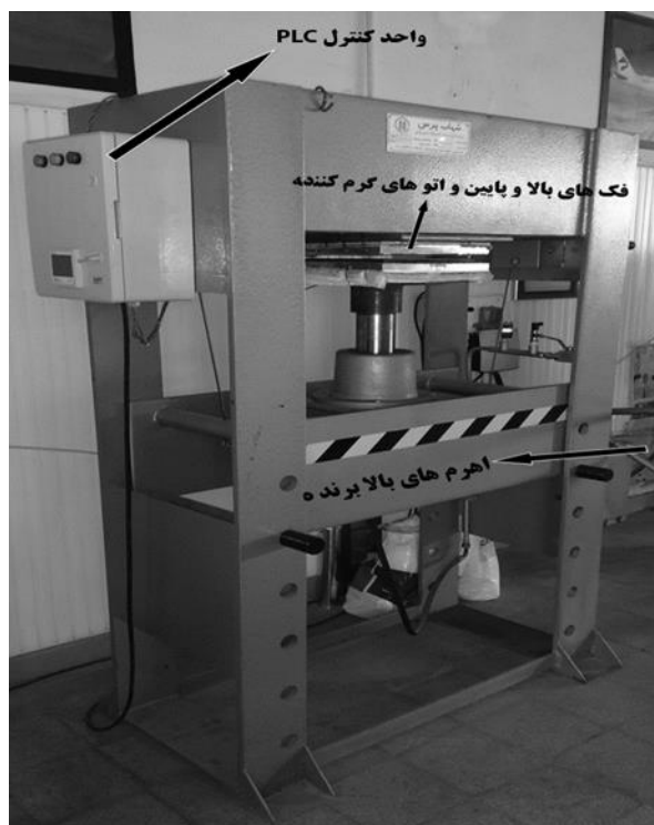
شکل ۳) دستگاه پرس گرم با واحد کنترل کنترل PLC و تشریح قسمت‌های آن.
