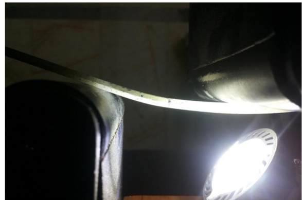
شکل 10 تعیین محل نوک ترک با روش نورپردازی
