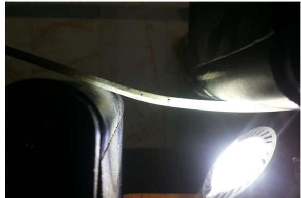
شکل 6 تعیین محل نوک ترک با روش نورپردازی
